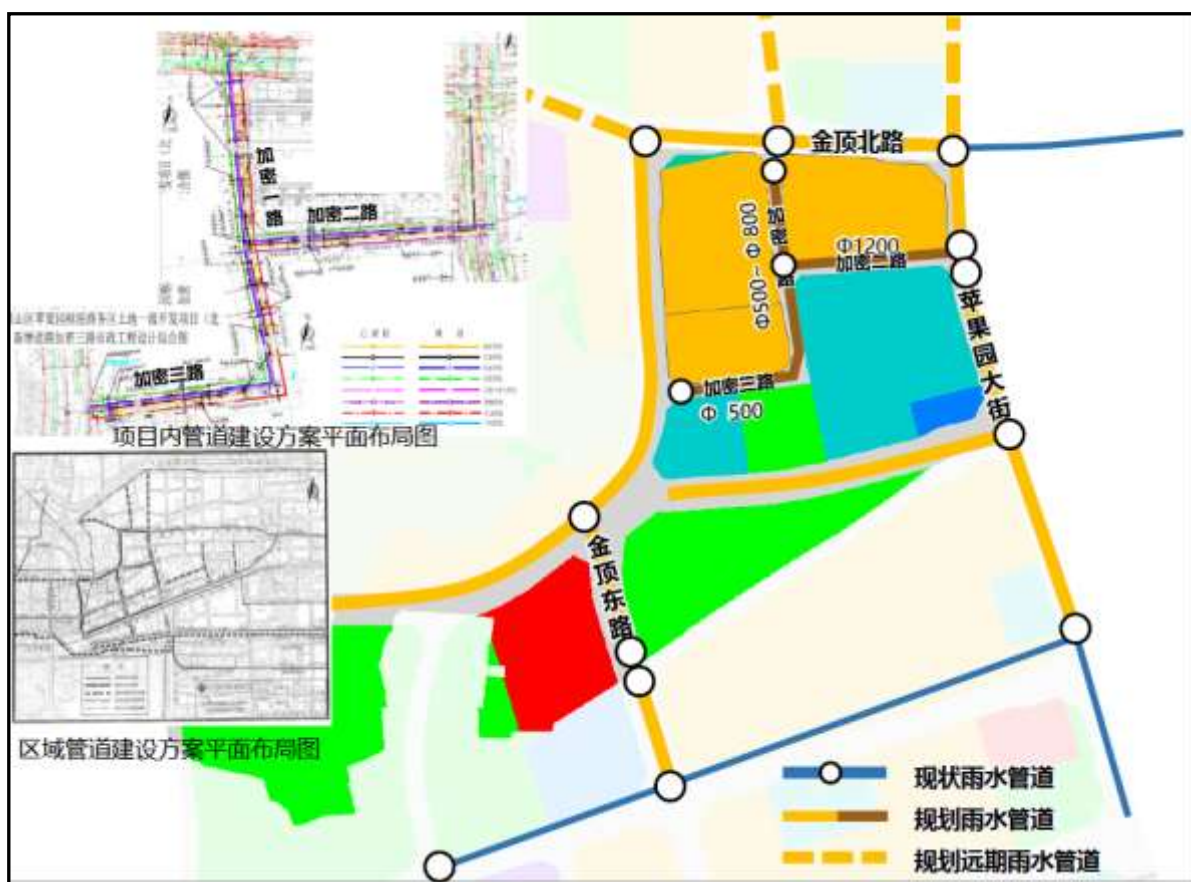
图 2-6 项目所在区域雨水管线规划示意图
