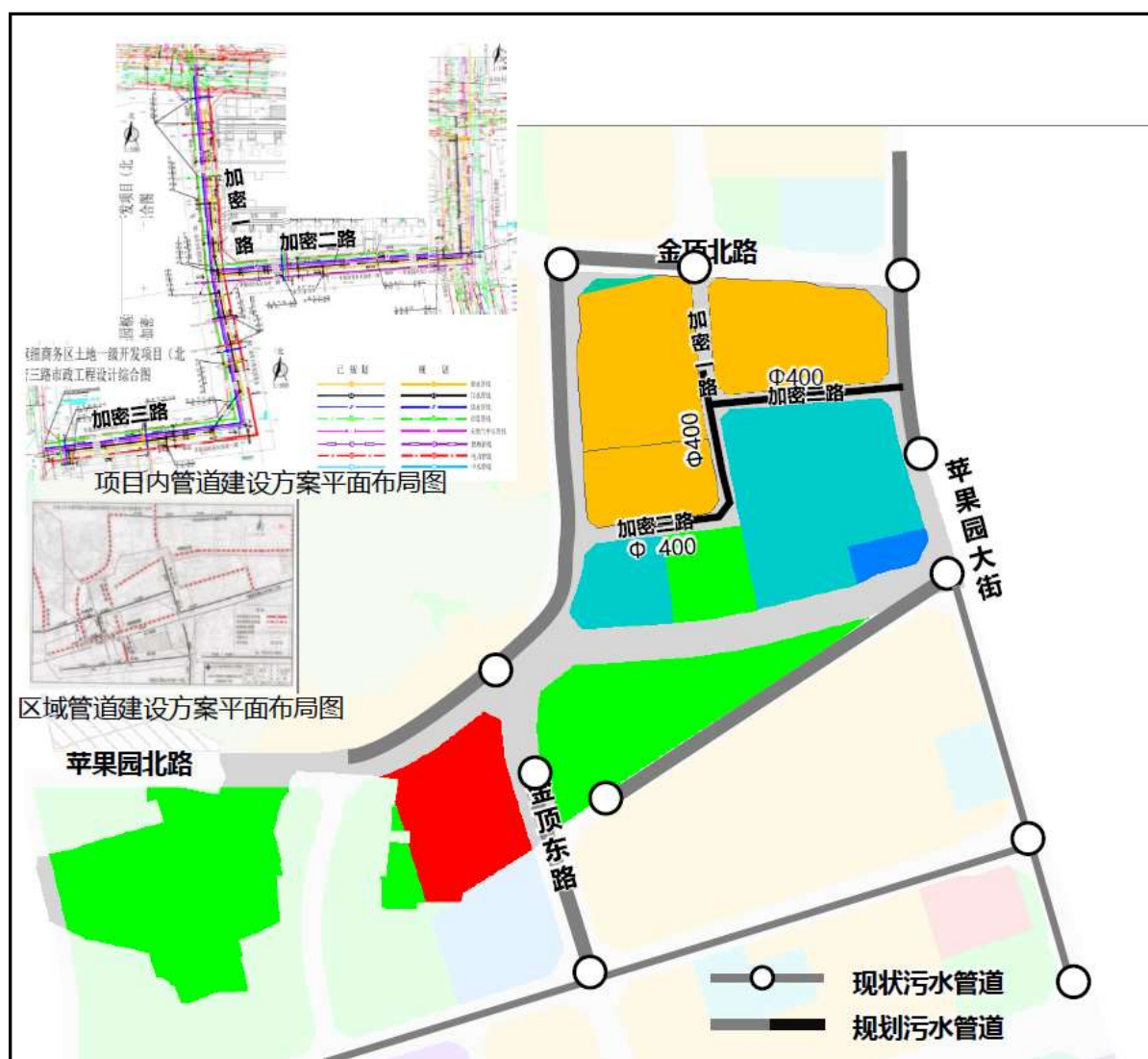
图 2-7 项目所在区域污水管线规划示意图
