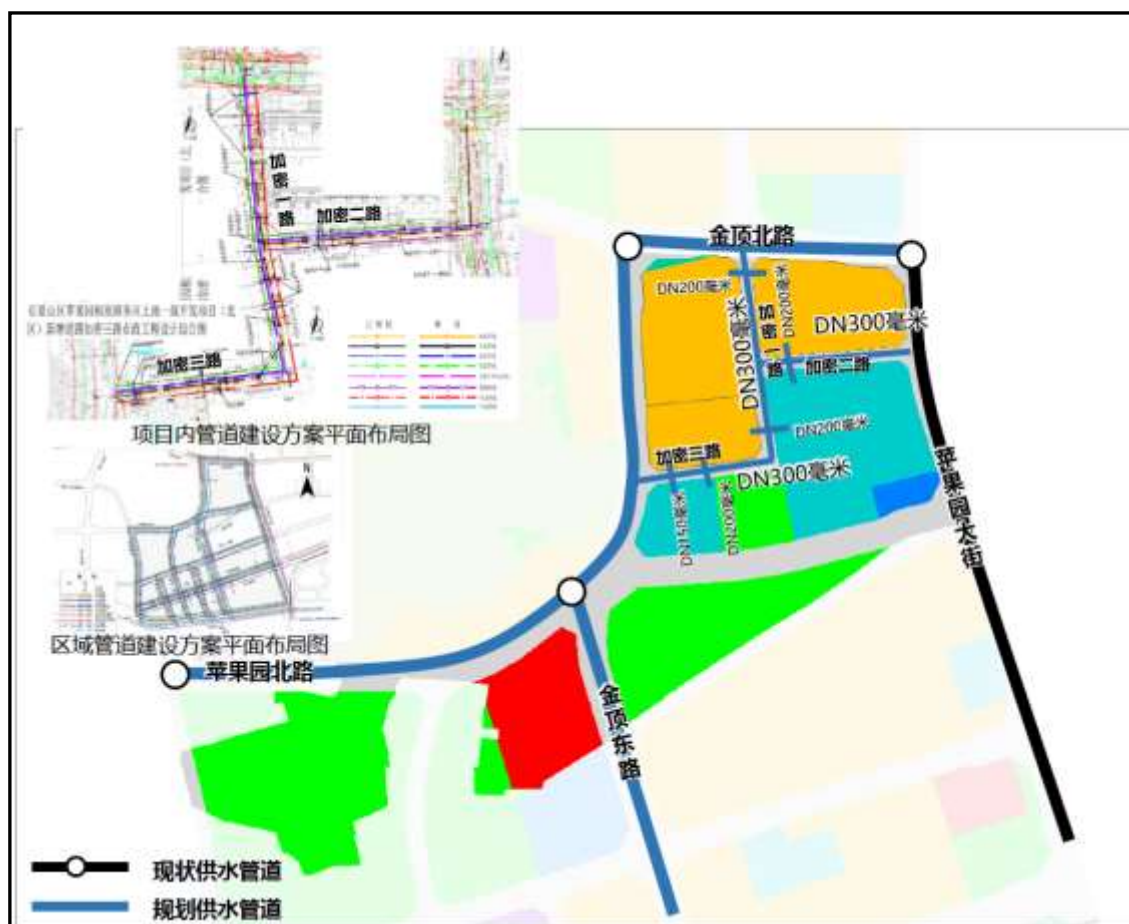
图 2-4 项目所在区域供水管线规划示意图
