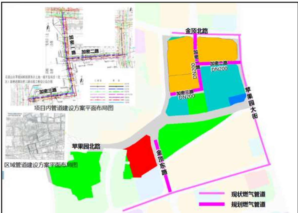
图 2-9 项目所在区域供气管线规划示意图
